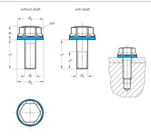
A/F = 22 d1 = M16 d2 = 28 d3 = 28.8 I1 without shaft = -I1 with shaft = 50
